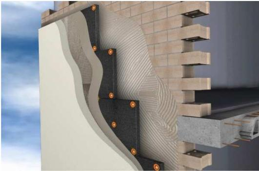
Sistema de aislamiento térmico colocado por el exterior, fijado mecánicamente a la fachada, que consta de 6 cm de poliestireno expandido con un acabado de mortero acrílico. Se estima su coste de ejecución material con andamiaje incluido en 62.130,31 € que repercuten **3.106,52 €/Vivienda** y su vida útil en 50 años. La
